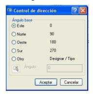
Que admite 0° para los cuatro puntos cardinales, (0°, 90°, 180°, 270°, 360°), o dentro de **"Otro"**, admite el ángulo 0° en cualquier dirección proporcionada.
