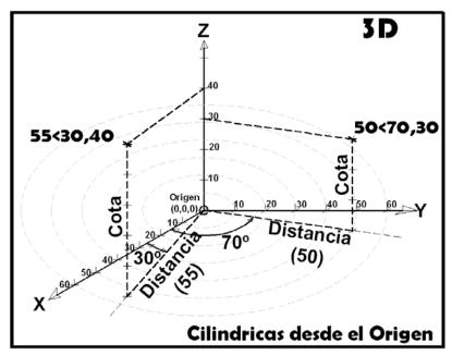
Se sitúan dos puntos, el primero de ellos a **55 unidades** del origen, con un ángulo en el plano **XY** de **30 grados** y una cota de **40 unidades**. El segundo situado a **50 unidades** del origen, con un ángulo en el plano **XY** de **70 grados** y una cota de **30 unidades**.
