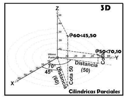
Se sitúan dos puntos, el primero de ellos a **60 unidades** del punto designado anteriormente, con un ángulo en el plano **XY** de **45 grados** y una cota de **50 unidades**. El segundo situado a **50 unidades** del punto designado anteriormente, con un ángulo en el plano **XY** de **70 grados** y una cota de **10 unidades**.
